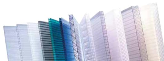
Il **Makrolon® multi UV 4/10-6** è una lastra alveolare di 10 mm di spessore a quattro pareti in polycarbonato. Le caratteristiche della lastra permettono di combinare un grado elevato di trasmissione di luce con un ottimo isolamento termico e una buona capacità di portata grazie alla sua sezione ad Y. La lastra è, inoltre, leggera, resistente agli urti e facile da montare.
